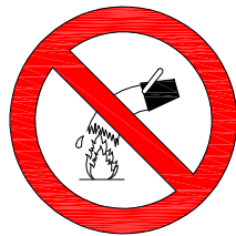
PROHIBIT APAGAR AMB AIGUA
